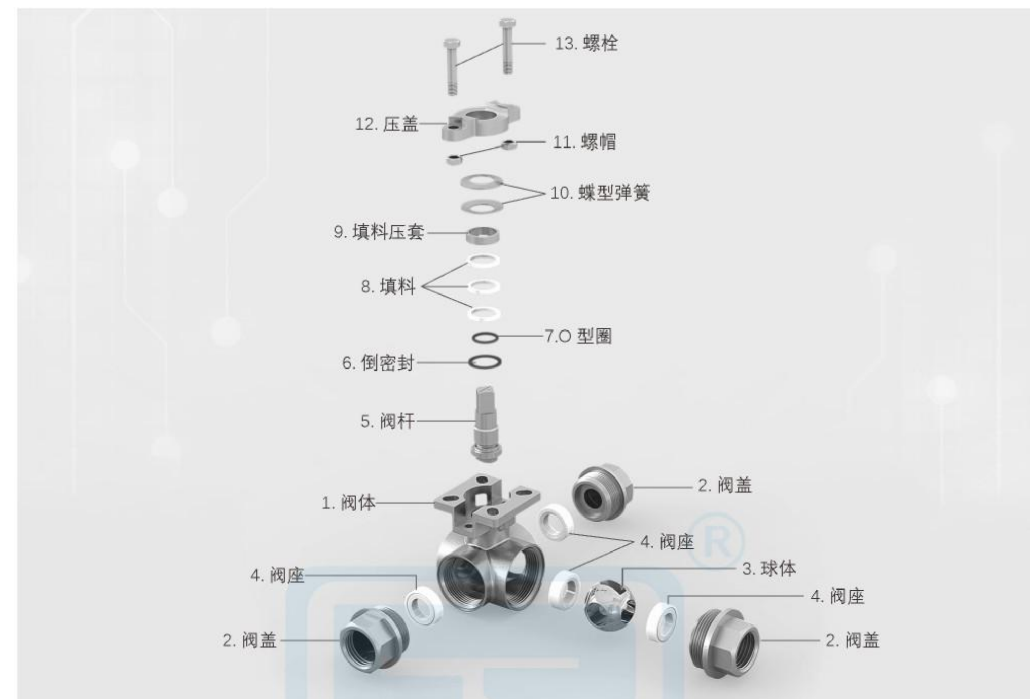
主要零件材料 Material parts materials
